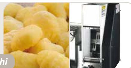
Gruppo formatore da innestare su P.NUOVA per produrre gnocchi di patate o di sfarinati in due diversi formati anche con componenti aggiunti come pomodori e spinaci. L'innesto sulla macchina avviene in modo semplice e pratico. Il gruppo può essere utilizzato anche su altre macchine di nostra produzione.
